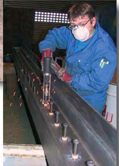
Wir können Bolzen bis zu 22 mm Durchmesser versetzen. Zulassung nach EN ISO 14555 für Baustähle (S235JRG2, S355J2G3) und Rostfreies Material (1.4301)
